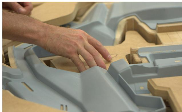
Un moule en silicone a généralement une durée de vie de 2 ans. Cela dépend principalement de la géométrie de la pièce.
