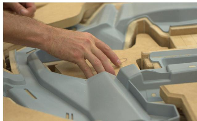
Un moule en silicone ont généralement une durée de vie de 2 ans. Cela dépend principalement de la géométrie de la pièce.
